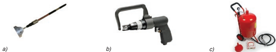
Slika 9 Alati za skidanje korozije a) dlijeto za odstranjivanje hrđe; b) pištolj za skidanje hrđe; c) stroj za pjeskarenje
