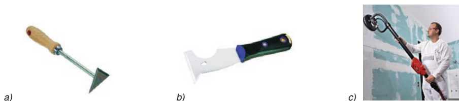
Slika 8 Alati za skidanje starih premaza: a) strugač boje s listom; b) strugač za boju; c) stroj za uklanjanje
